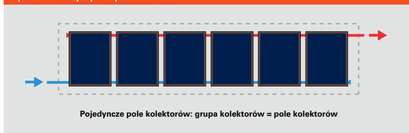
Rys. C.1.1-1 Pojedyncze pole kolektorów
