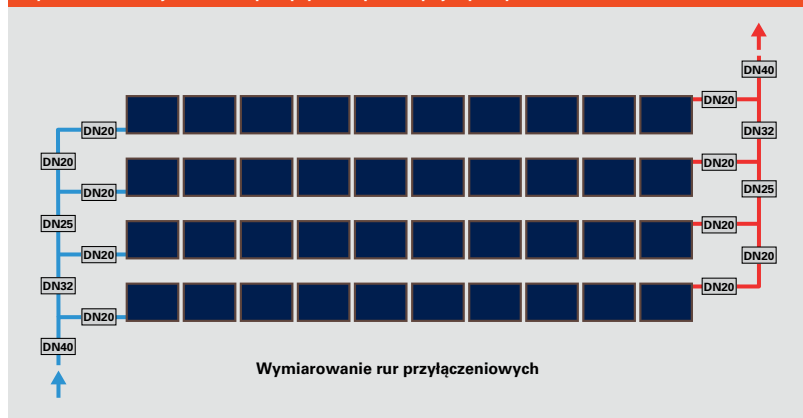
Rys. C.1.2-6 Projektowanie przepływu w polach pojedynczych
