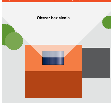
Rys. B.1.6–3 Zacielenie (widok z góry)
