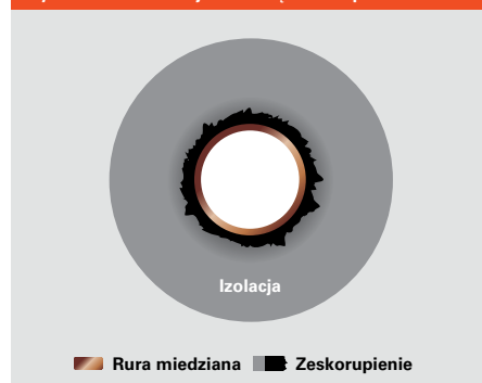
Rys. B.3.2-4 Izolacja ze strefą zeskorupienia
